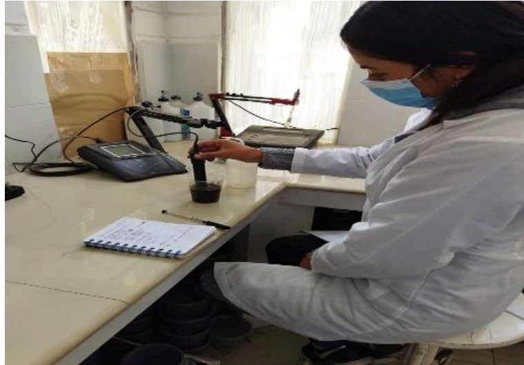
Figura 29-2: Medición de conductividad
