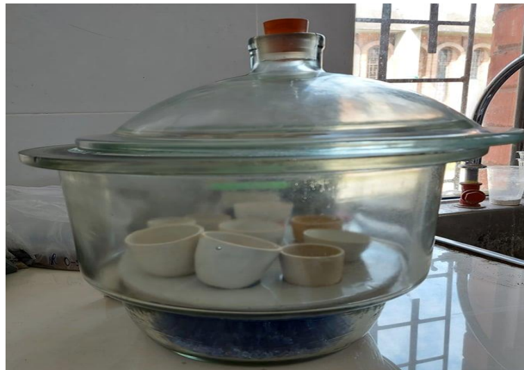
Figura 39-2: Muestras de suelo en crisoles colocados en el desecador
