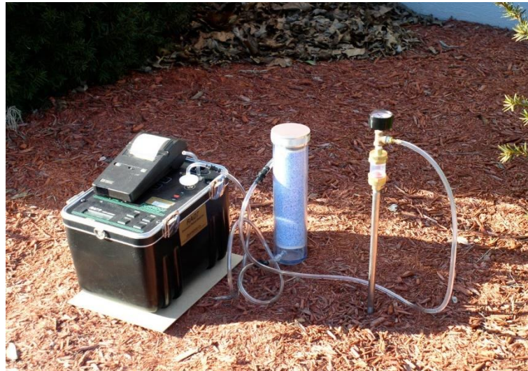
Figura 4-1: Sistema de detección de gas radón
