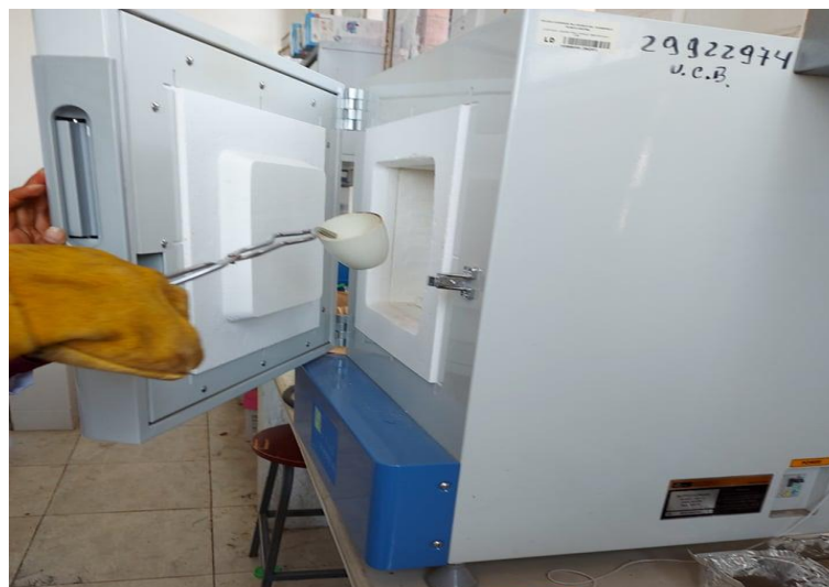
Figura 36-2: Crisoles en el horno mufla
