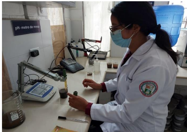
Figura 28-2: Medición de pH
