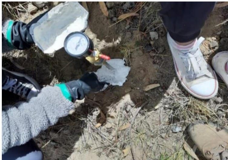
Figura 20-2: Colocación de yeso alrededor de la sonda
