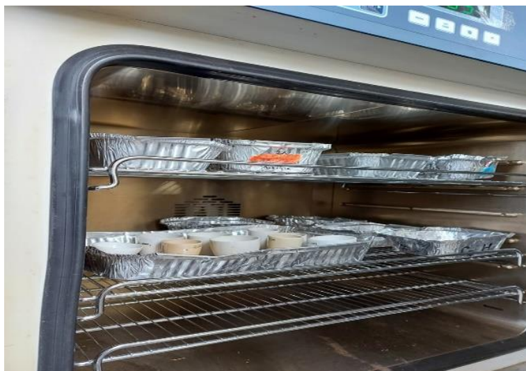
Figura 38-2: Muestras de suelo en crisoles ubicados en la mufla
