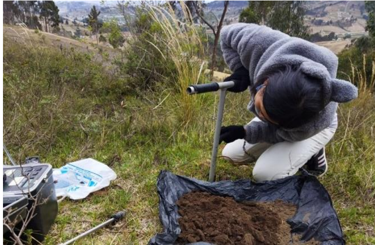
Figura 19-2: Perforación del suelo
