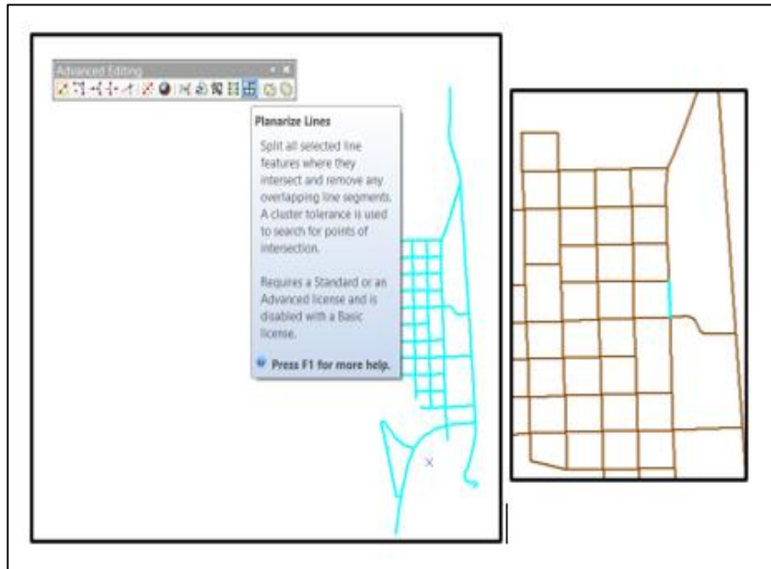
Figura 17-3. División por segmentos de líneas
