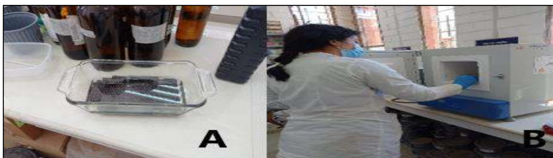
Figura 10-2: Tratamiento de membranas anódicas. A: ánodos en solución de sulfato de amonio. B: Calentamiento de ánodos.
