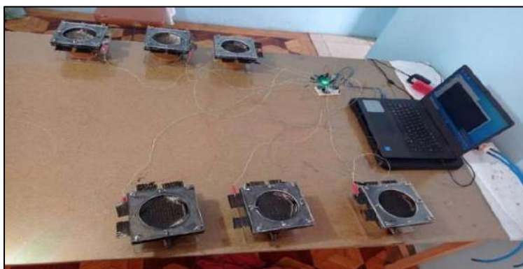
Figura 1-2: Instalaciones de monitoreo de las MFCs
