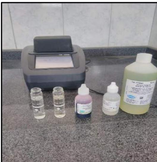
**Fotografía 50.** Espectrofotometría NH<sub>3</sub>-H
