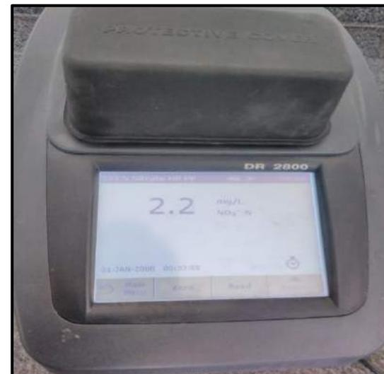
**Fotografía 45.** Espectrofotometría Nitratos
