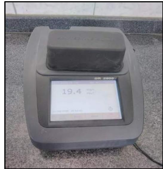
**Fotografía 49.** Espectrofotometría Fosfato
