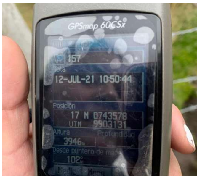
Figura 19: Uso de GPS para la toma de puntos
