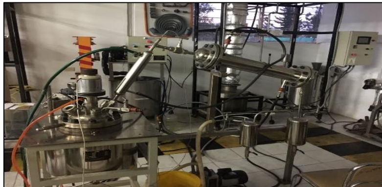
Figura 4-3: Reactor de Pirólisis
