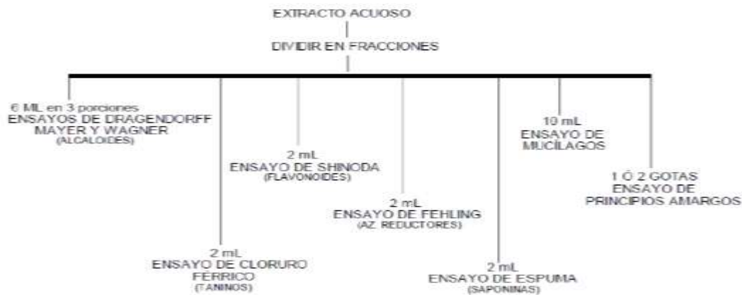
Figura 3-2: Ensayo a realizar en el extracto acuoso
