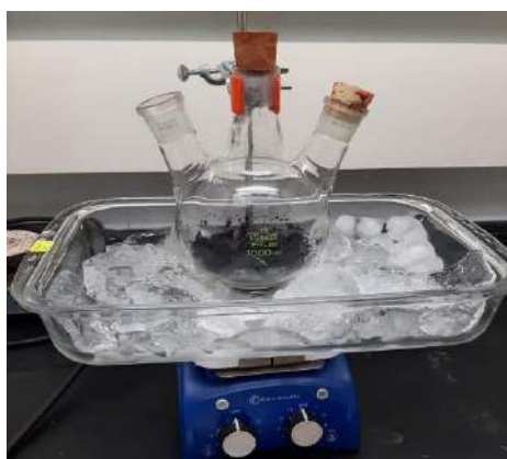
Gráfica 1B: Equipo armado con grafito y H_2SO_4
