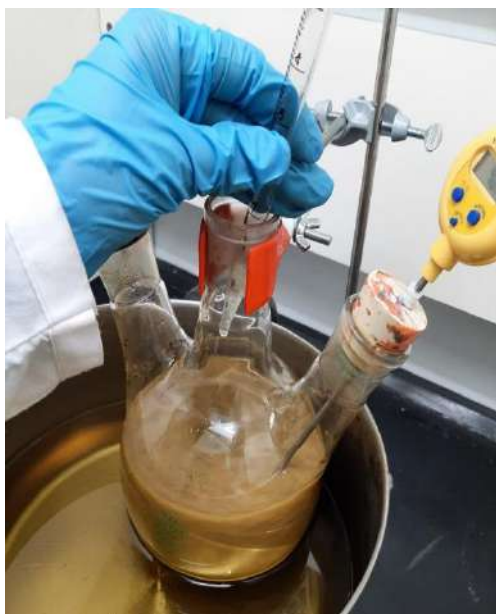
Gráfica 4B: Adición de H_2O_2 para detener la oxidación
