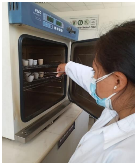
Gráfico 6-2: Colocación de las muestras en la estufa.
