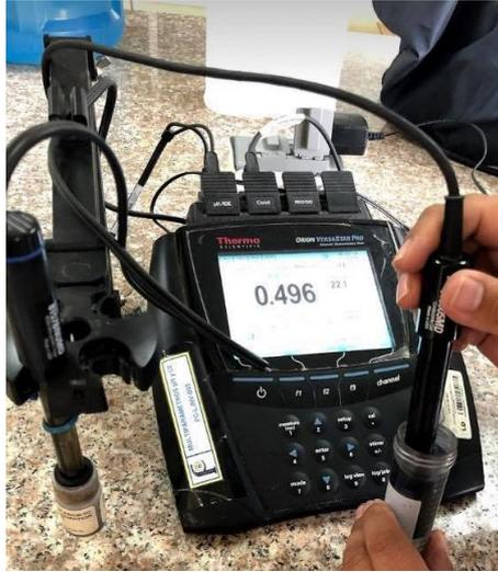
**Figura 4 - 2. Medidor multiparámetros pH y CE**
