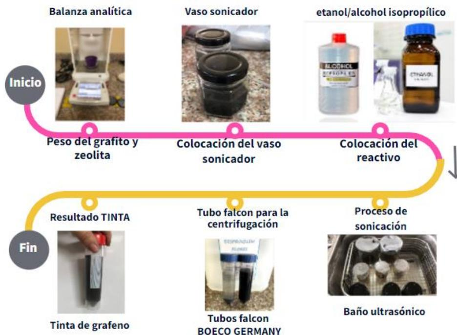
**Figura 1 - 2. Diagrama de bloques de las etapas para la obtención de grafeno**
