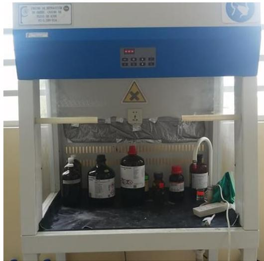
**Figura 22-2.** Sorbona o campana de extracción.
