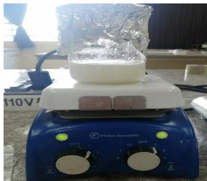
**Figura 21-2.** Agitador magnético con placa calefactora.
