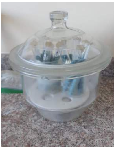
Permeabilidad al vapor de agua
