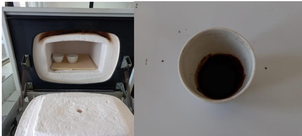
Ensayo de Cenizas Sulfúricas de la Urea
