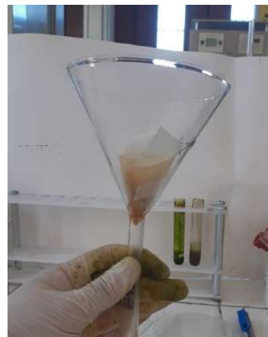
Gráfico 4B. Cenizas insolubles en HCl
