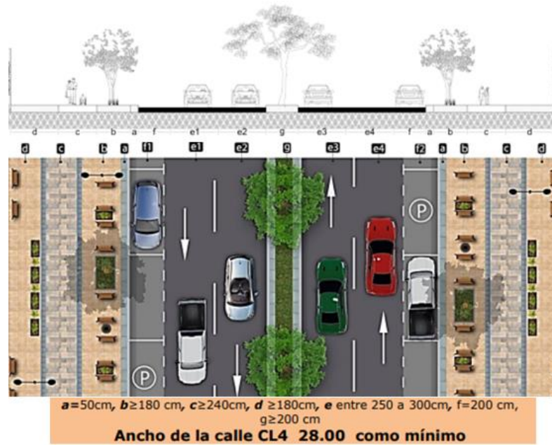
Figura 3-1: Calle local CL4 con medidas referenciales Fuente: “Manual de diseño de calles activas y caminables, 2016”
