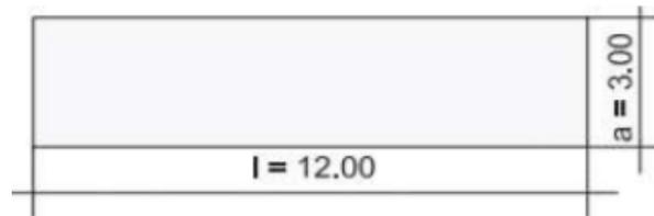
Para este Plan se hizo un ensanchamiento de la calzada de 3 metros y una longitud de (12 m del bus + 21,60 m que es el espacio que el transporte necesita para ingresar y salir del área de estacionamiento), dando un total de 33.60 m de extenso, con la intención de limitar el sector donde los buses de transporte público logren detenerse para tomar y/o dejar pasajeros en forma segura, su color es blanco.
