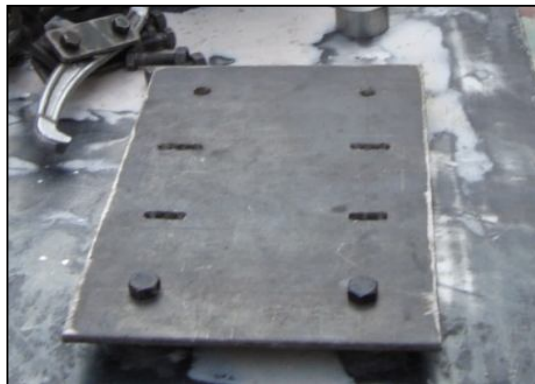
Figura 4.14: Colocación de la Base del Motor.
