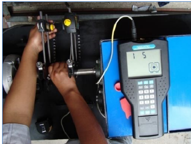
Figura 6.5: Calibrar el Láser entre el Emisor y Reflector
