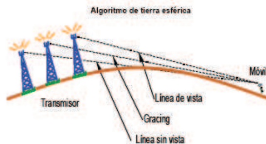
FIGURA IV.08.- Algoritmo para la curvatura de la tierra
