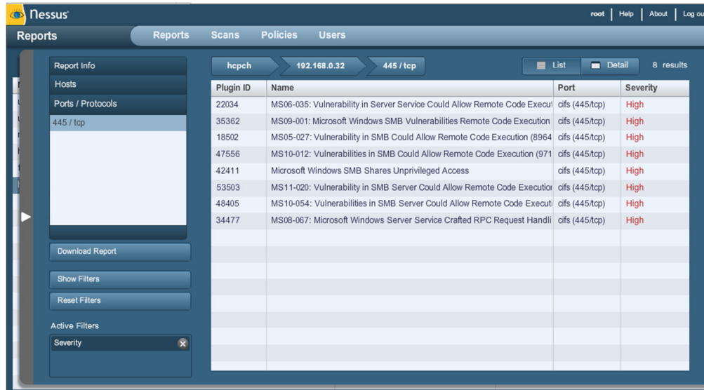
Figura III.34 Resumen de las Vulnerabilidades encontradas en el servidor de Pruebas
