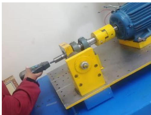
Figura 11-2: Monitoreo de velocidad con tacómetro.
