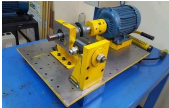
Figura 9-2: Banco de pruebas de rodamientos BPR-6206
