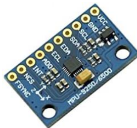
Figura 6-3: Sensor de vibración MPU9250
