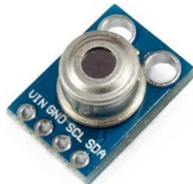
Figura 1-3: Sensor de temperatura MLX90614
