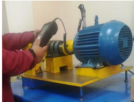
Figura 12-2: Monitoreo de vibración con VibraCHECK
