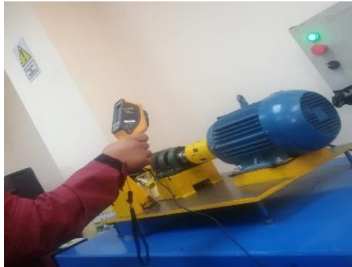
Figura 10-2: Monitoreo de temperatura con cámara térmica
