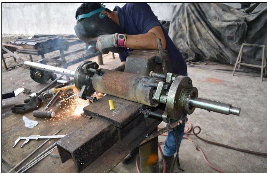
Figura 4-4. Colocación del eje y soldadura de manzanas en el elemento a mandrinar
