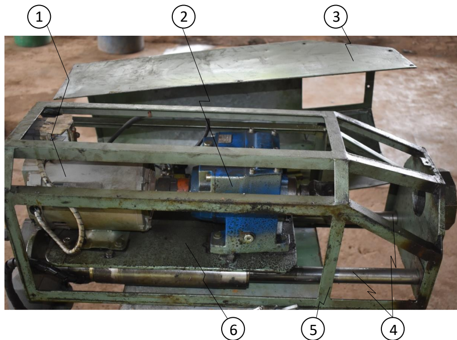
Figura 2-3: Componentes principales mandrinadora portátil
