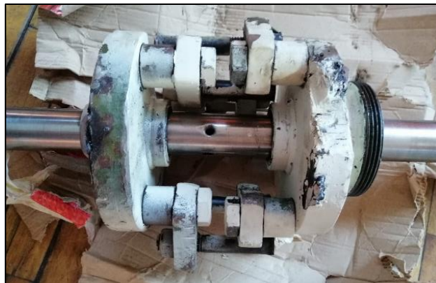
Figura 12-3: Eje principal con manzanas reparadas
