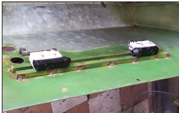
Figura 19-3: Vista interior de la carcasa mariposas finales de carrera
