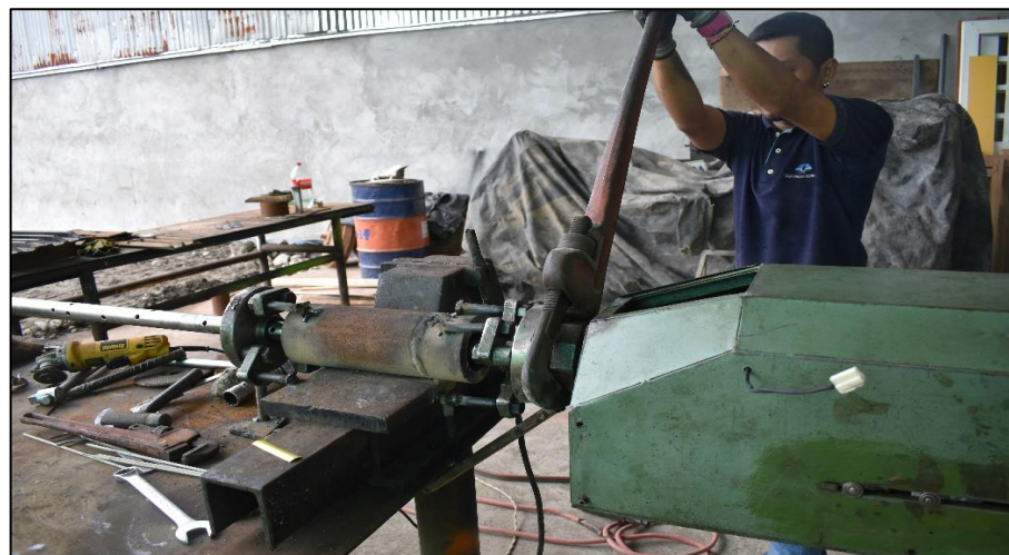
Figura 5-4. Colocación y ajuste de la mandrinadora al eje principal.
