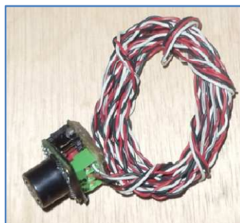
Figura III.22. Sensor Ultrasónico MaxSonar EZ1
