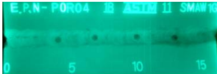
Figura 2-3. Porosidades en un cordón de soldadura vista mediante radiografía
