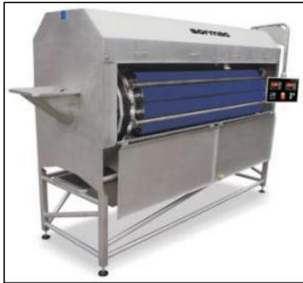
Figura 6-2: Máquina de lavado con eje cepillos Fuente: Yandún Bolaños (2020)
