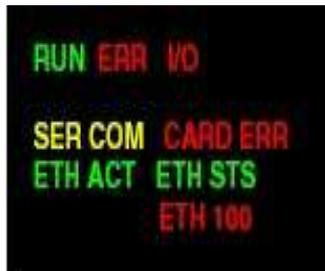
**Figura 34:** Leds indicadores de estado
