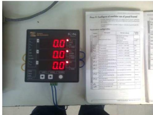
Configurando los parámetros del medidor de energía ION 6200
