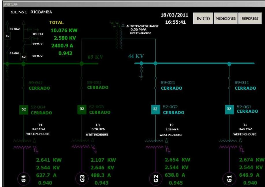
Figura 163: Diagrama unifilar de la central hidroeléctrica ALAO
