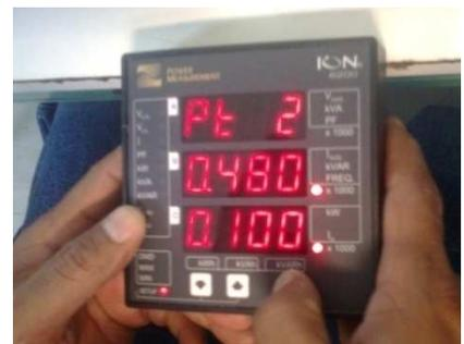
Configuración entradas de voltaje del TT primario, escalamiento, TT secundario (respectivamente).
