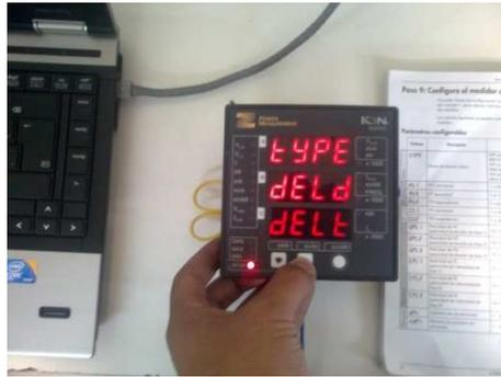
Configuración del tipo de conexión
