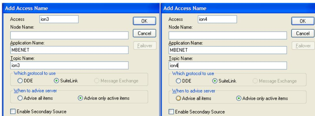
**Figura 136:** Configuración del Access Name para el medidor del grupo 3 y 4
