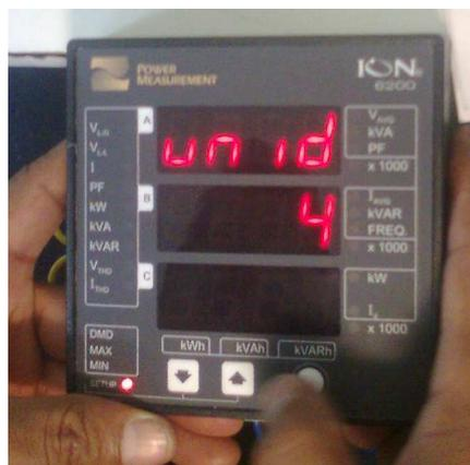
Configuración identificador de dispositivo para la comunicación MODBUS
