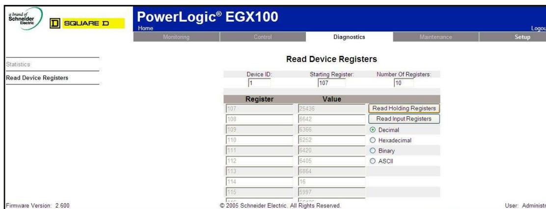
**Figura 115:** Entorno de lectura de los registros del medidor de energía
