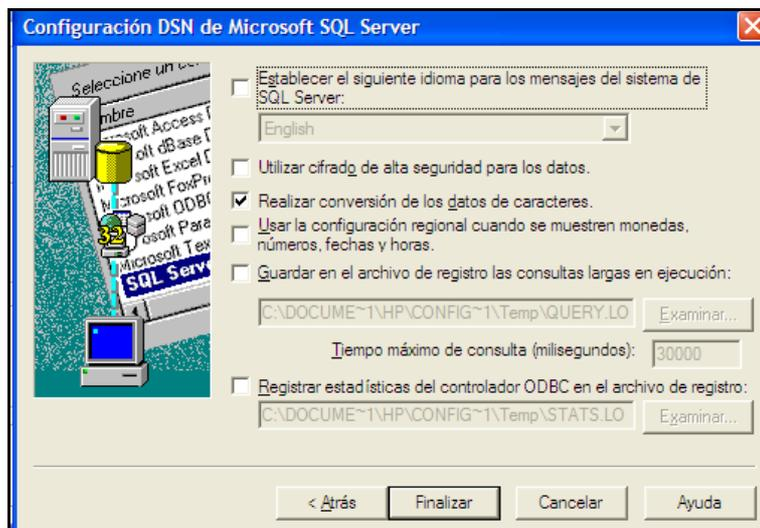
**Figura 153:** Finalización del origen de la conexión de INTOUCH mediante ODBC
