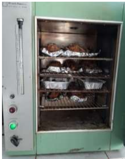
Figura 7-2 Determinación de humedad
