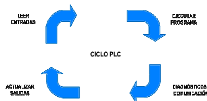
Fig. V-25.- Ciclo de Funcionamiento del CPU de un PLC
