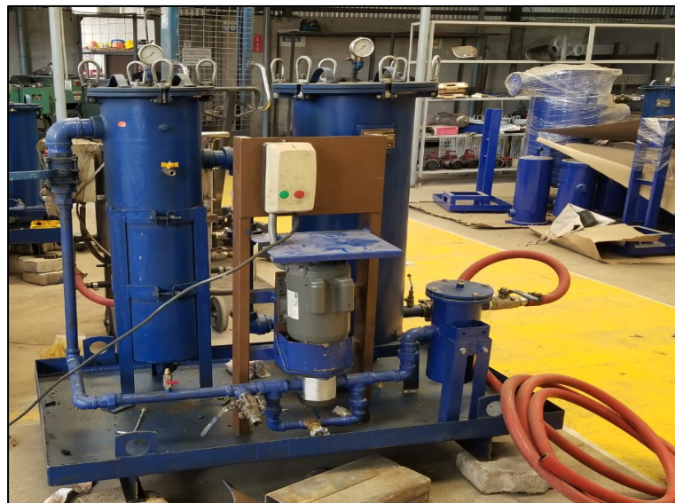
Figura 4-2: Sistema de filtrado diésel
