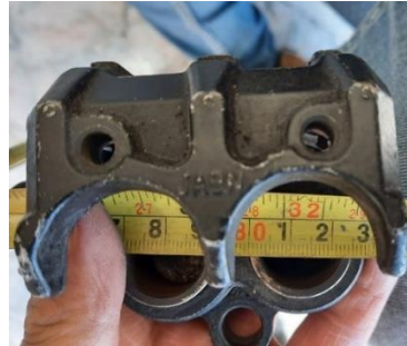
Figura 2-3: Diámetro pistón de la mordaza del freno
