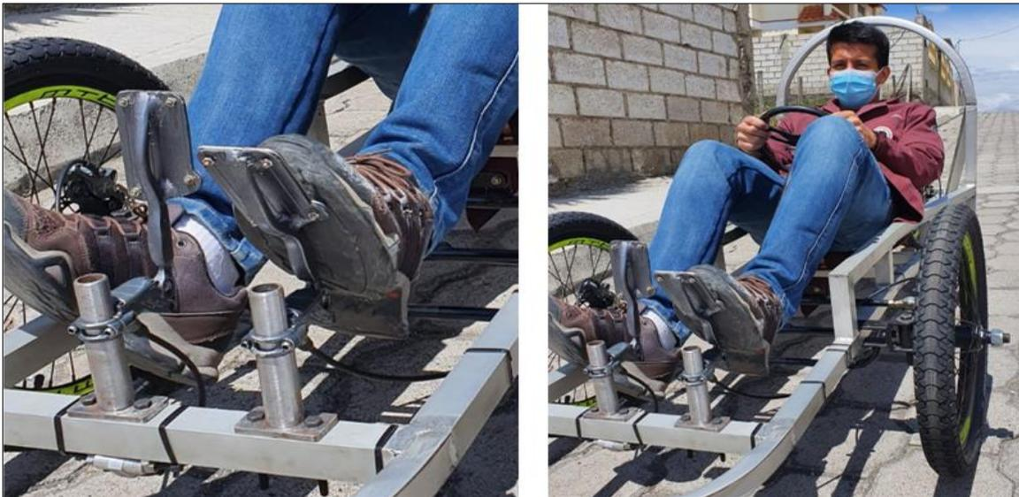
**Figura 2-4:** Accionamiento del freno para el eje posterior.
