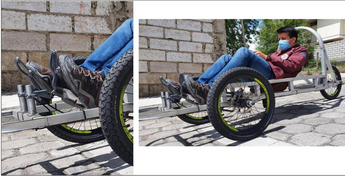
**Figura 1-4:** Accionamiento del freno para el eje frontal.
