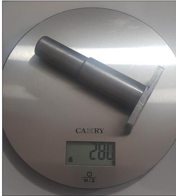
**Figura 20-3:** Peso del soporte de freno.
