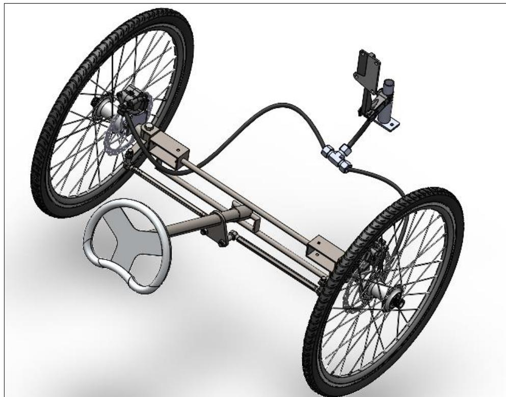
**Figura 17-3:** Sistema de freno para el eje frontal.
