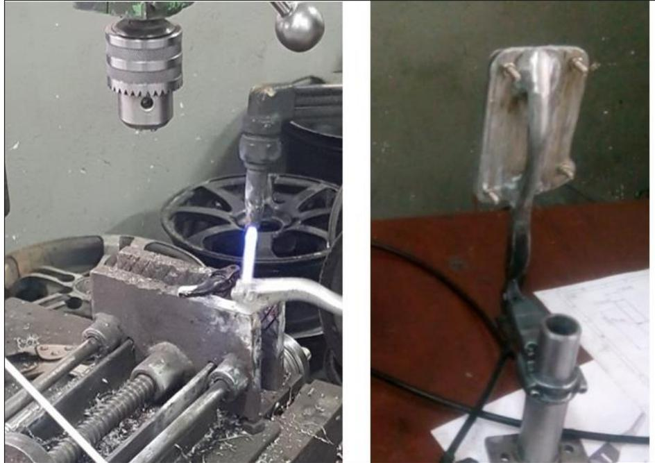
**Figura 21-3:** Construcción del pedal de freno.
