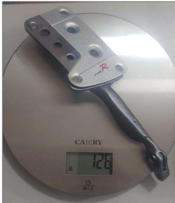
**Figura 22-3:** Peso del pedal de freno.
