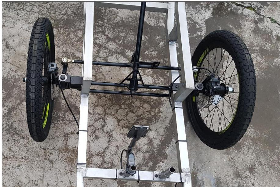
**Figura 31-3:** Ensamble del sistema de freno frontal.
