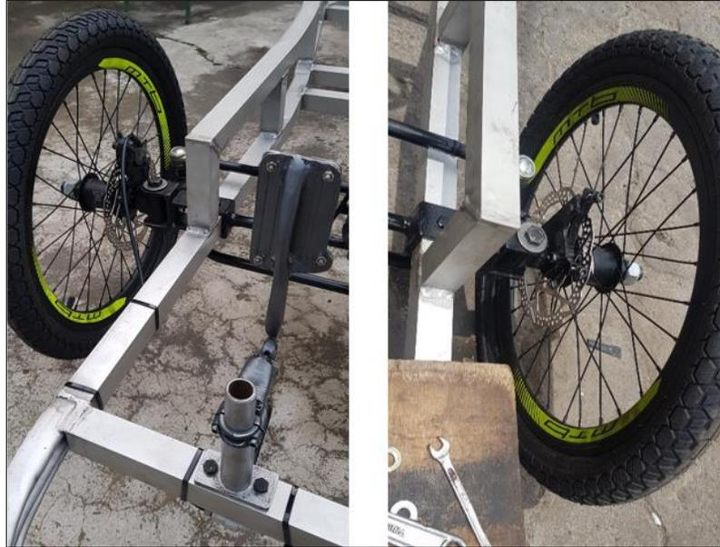
**Figura 30-3:** Soporte del sistema de freno frontal.
