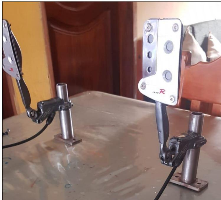
**Figura 27-3:** Ensamble del accionamiento del sistema de freno.
