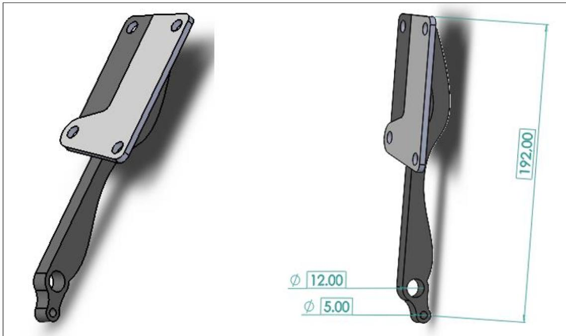
**Figura 10-3:** Diseño del pedal de freno.
