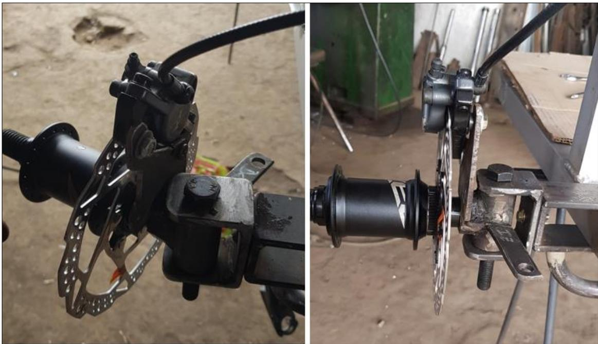
**Figura 24-3:** Soporte para las mordazas de freno delanteras.
