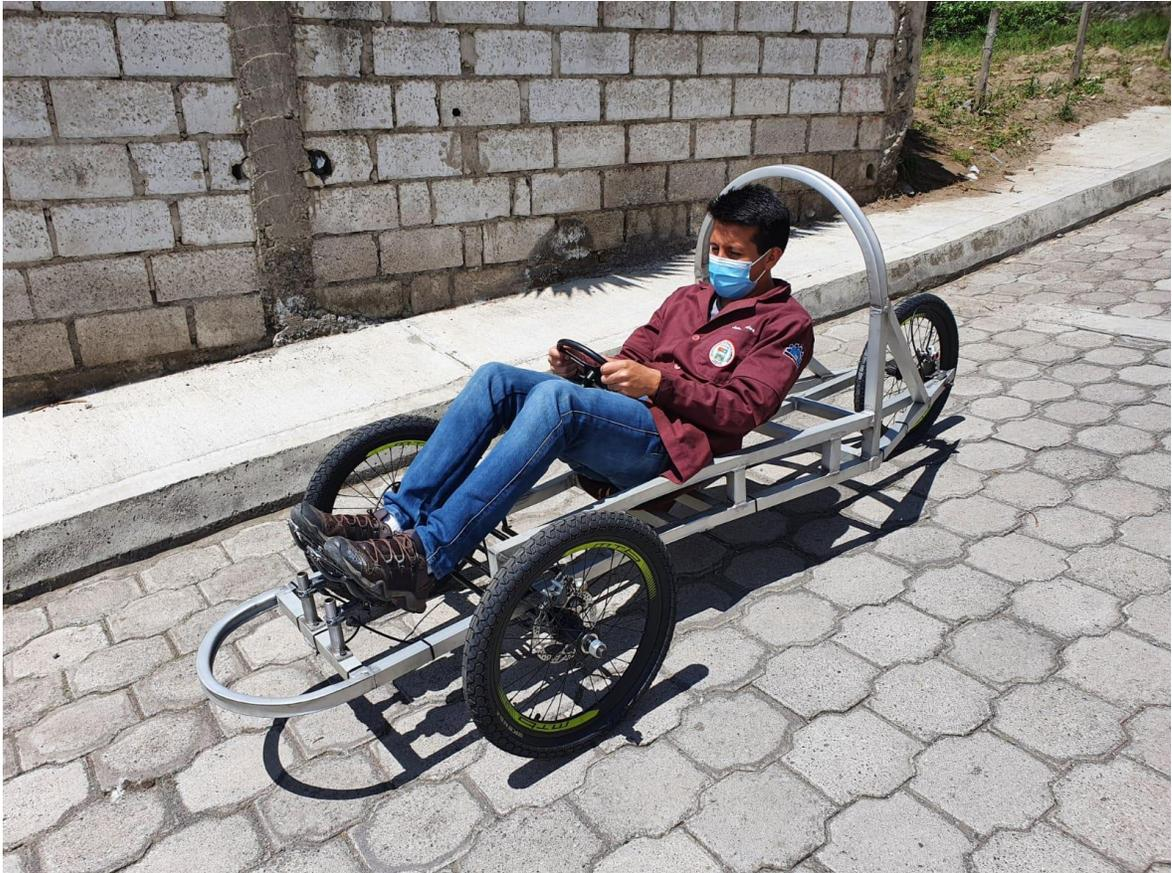
**Figura 39-3:** Prueba de campo en pendiente al 20%
