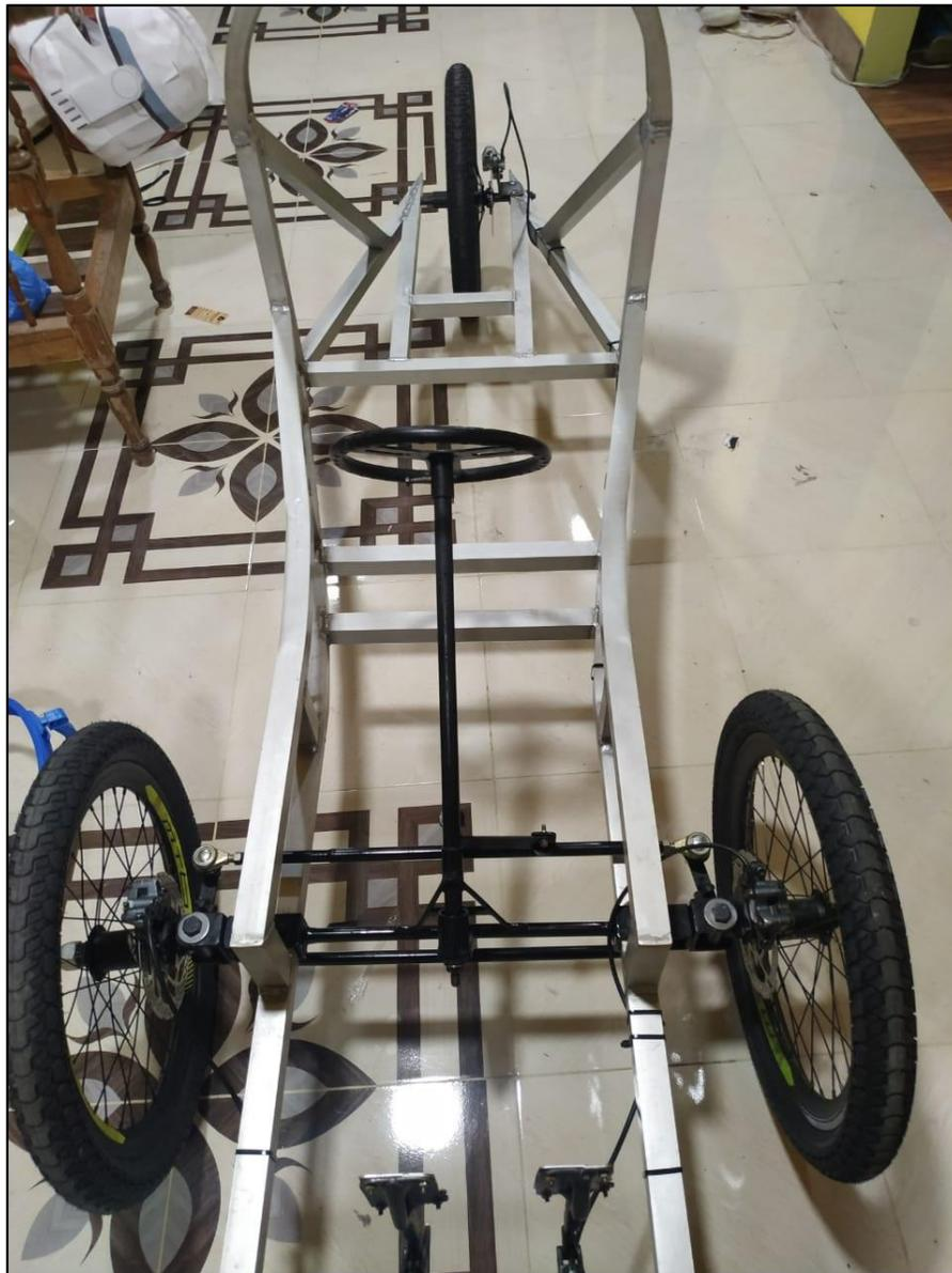
**Figura 32-3:** Ensamble final del sistema de freno en el prototipo monoplace.
