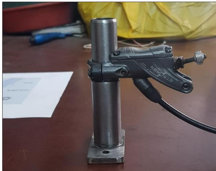
**Figura 26-3:** Ensamble del soporte y cilindro maestro.
