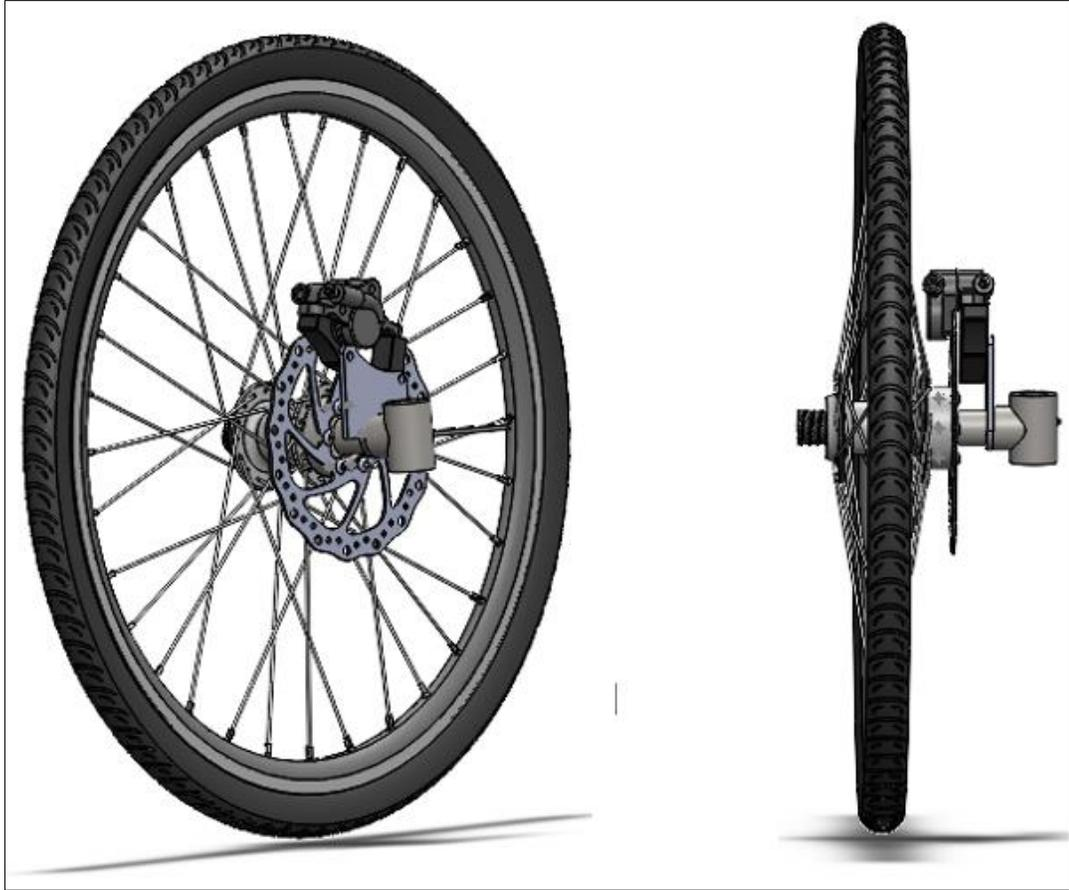
**Figura 13-3:** Diseño del soporte de mordaza delantera junto a la rueda.
