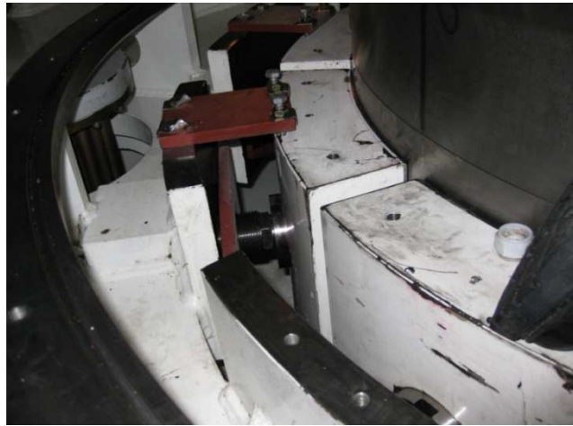
Figura 2.7. Cojinete guía inferior del generador.
