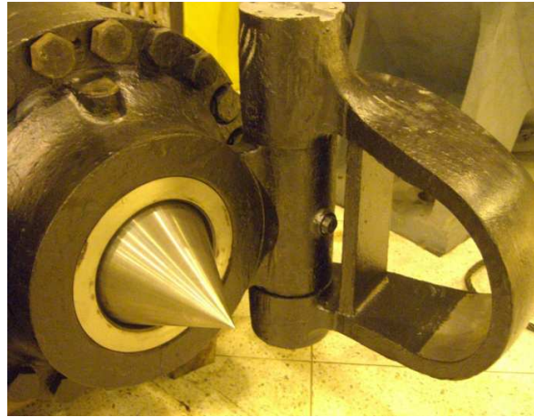
Figura 2.14: Inyector y deflector de la Turbina.
