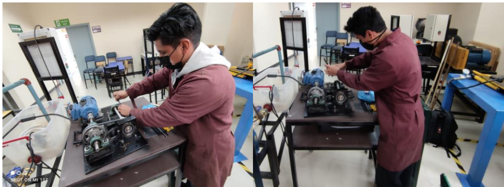
Gráfico 4-2: Desmontaje de chumaceras acopladas al eje conducido
