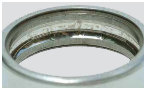
Figura 2-1: Aro exterior de rodamiento rígido de bolas
