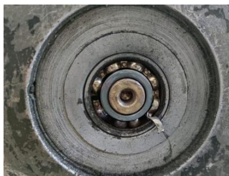
Gráfico 17-2: Canastilla rota del rodamiento
