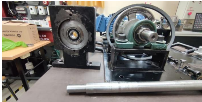
Gráfico 8-2: Montaje de bocín en la caja de rodamiento y cilindrado de eje
