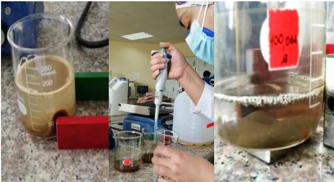
**Figura 2-2.** Proceso de purificación de las NPMs (magnetita)
