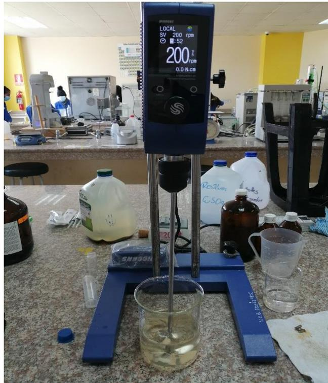
**Figura 4-2.** Adsorción de As en agua contaminada con NPMs (magnetita)
