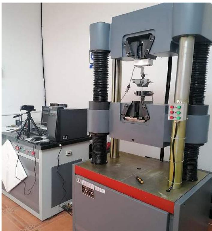
**Figura 3-3:** Ensayo de tracción realizado en el tratamiento 3
