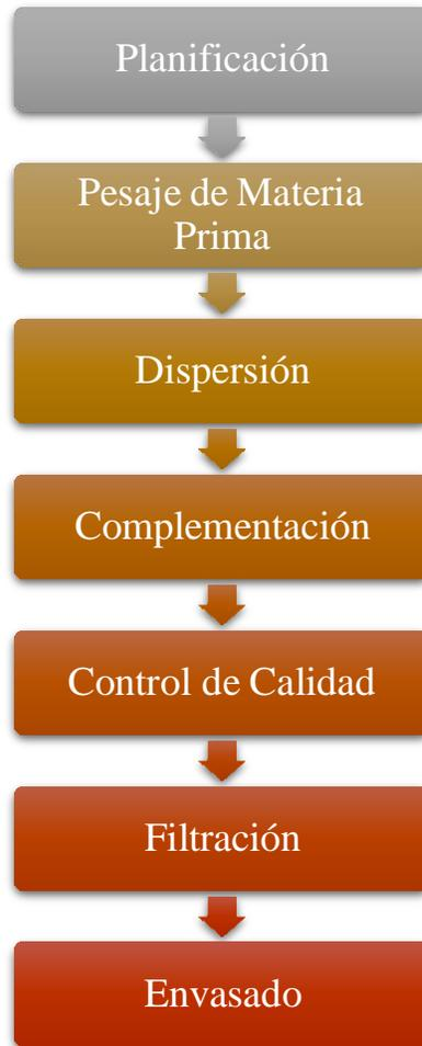
**Figura 6-3:** Diagrama de Producción de Pintura en Base Agua (Látex).
