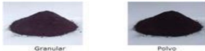
**Figura 8-1:** Clasificación del carbón activado por el tamaño del grano
