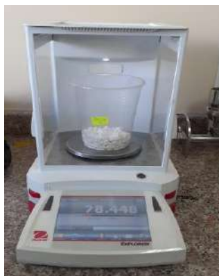
Figura 16-2. Pesaje del almidón de cáscara
