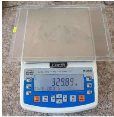
Figura 30-2. Pesaje de la biopelícula obtenida
