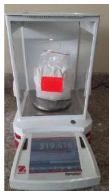
Figura 20-2. Pesaje del almidón de cáscara de papa.
