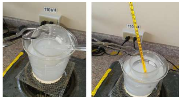
Figura 25-2. Calentamiento de la mezcla a baño María
