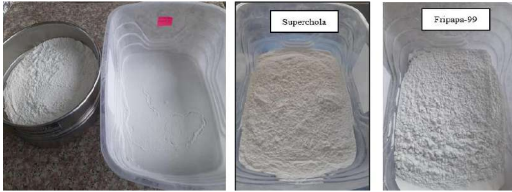
Figura 18-2. Tamizado del almidón de cáscara, por variedad (Superchola y Fripapa-99)
