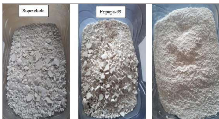
Figura 17-2. Molienda del almidón de cáscara, por variedad (Superchola y Fripapa-99)
