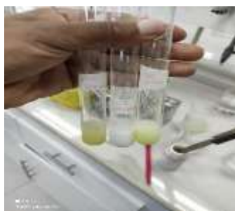
Figura 1-3: Prueba de determinación de cloro para todos los tipos de PVC
