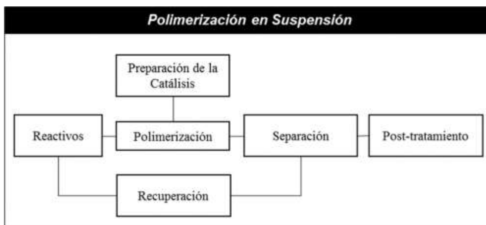
Figura 1-1: Diagrama representativo de los pasos para una polimerización en suspensión.
