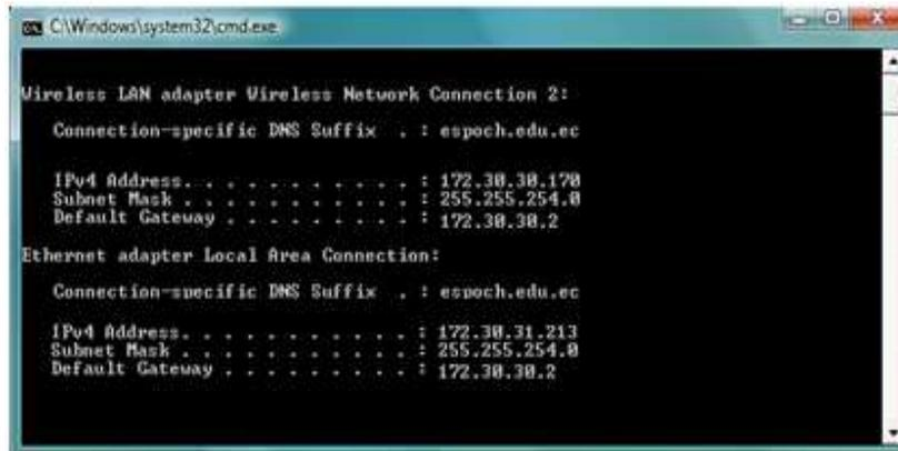
Figura III-82 Prueba del Servidor DHCP con IPv4
