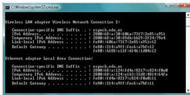
Figura III-89 Prueba del Servidor DHCP con IPv6
