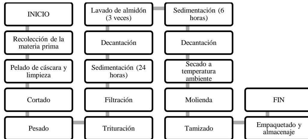
Gráfico 2-3: Diagrama de flujo de proceso de extracción de almidón de la yuca amarilla y pepa de aguacate
