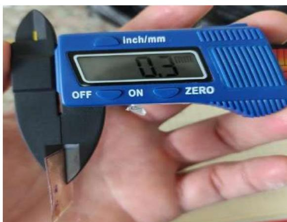
**Figura 5-3:** Medición de espesor de la biopelícula
