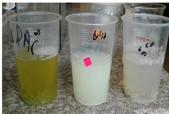
Figura 2-3. Agua Tratada con los tres floculantes.
