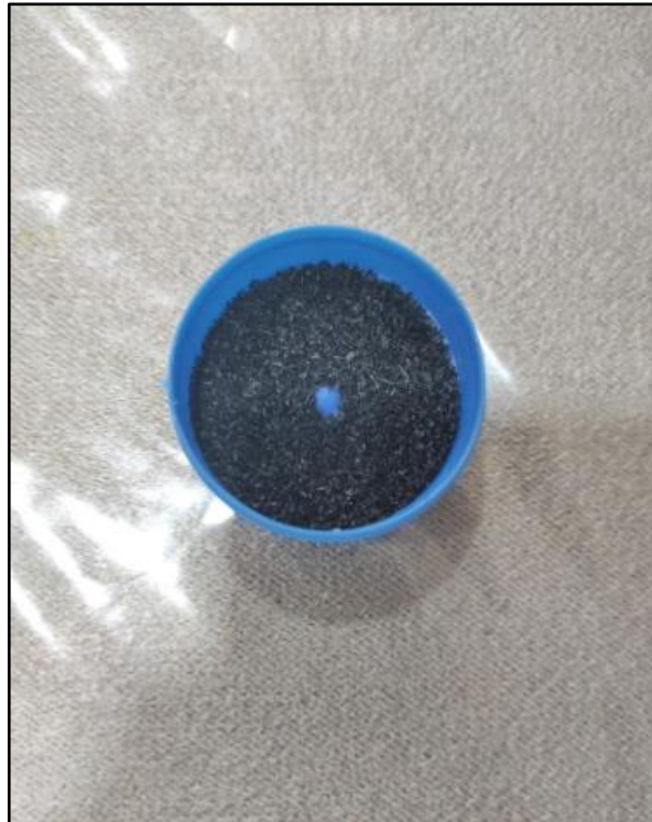
Figura 2-3: Muestra pulverizada de PLA para el TGA Realizado por: Mora, Melissa, 2021.
