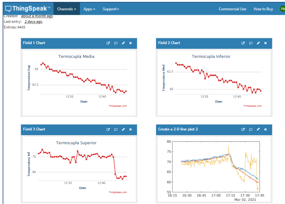
Figura 12-3. Interfaz de ThingSpeak para la visualización de temperaturas
