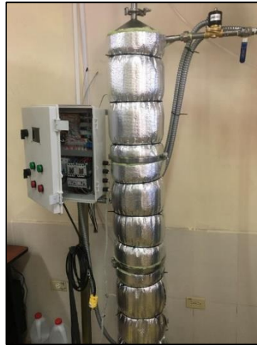
Figura 4-4. Torre de destilación
