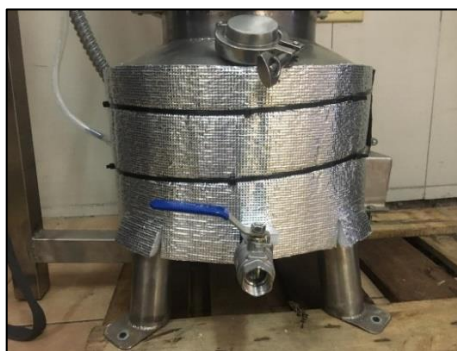
Figura 3-4. Tanque de alimentación
