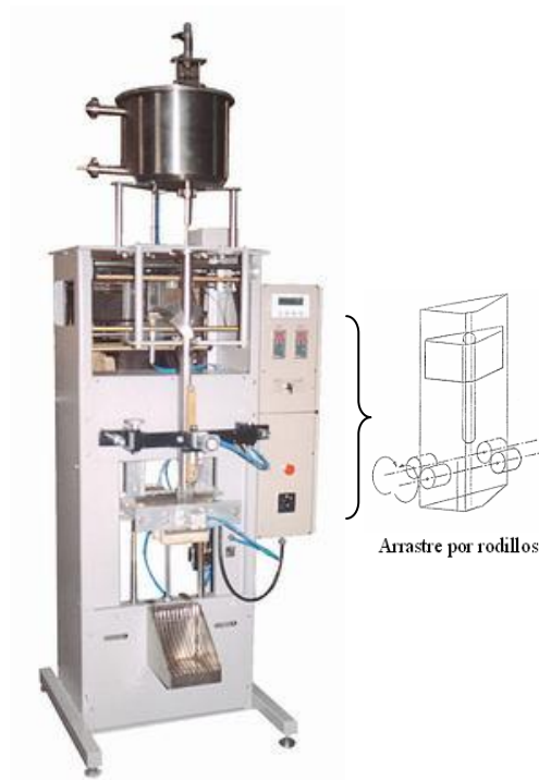
Figura 3.19: Equipo Automático (arrastre del plástico mediante rodillos)
