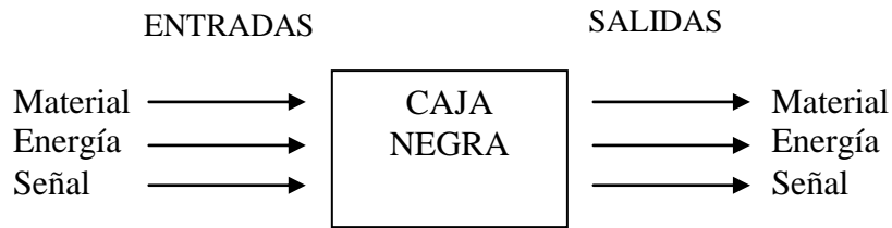
Figura 3.17: Estructura de Funciones
