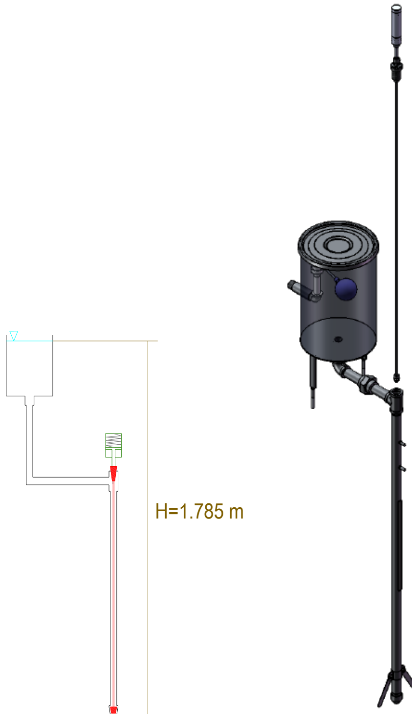
Figura 3.66: Sistema de Dosificado
