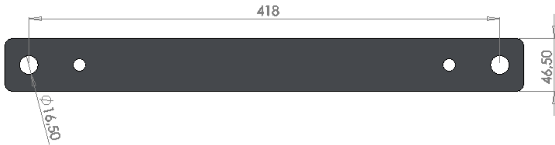
Figura 3.32: Dimensiones de la Placa (mm)
