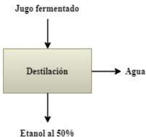
Figura 5-3: Diagrama del proceso de destilación del jugo de caña
