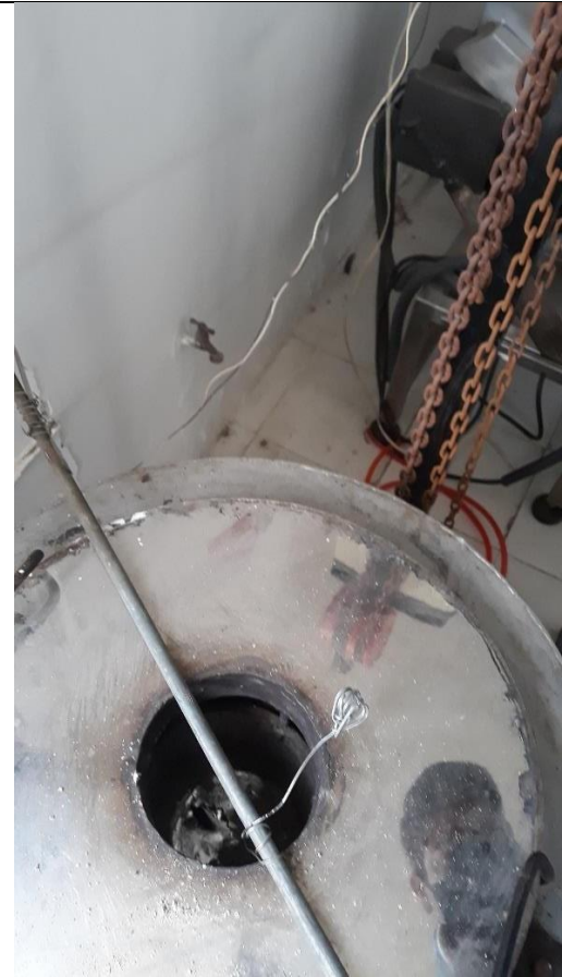
Inmersión de piezas en zinc fundido. Izquierda: Temperatura de los gases de combustión; centro: inmersión de piezas; derecha: zinc fundido en crisol
