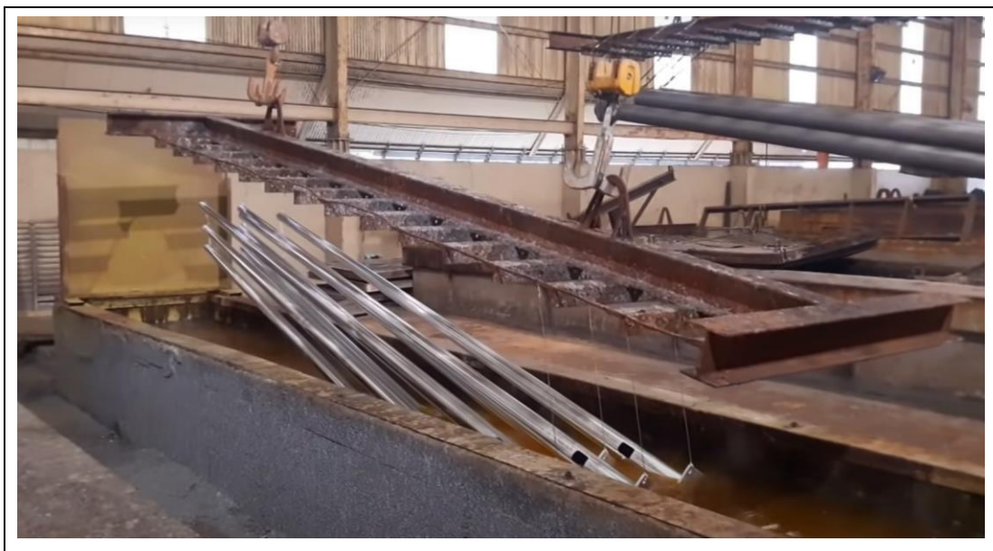
Figura 9-1. Enfriamiento de piezas.
