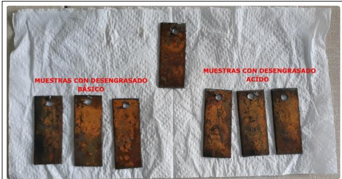
a) Placas de hierro oxidadas a las que se les va a aplicar los distintos tratamientos.
