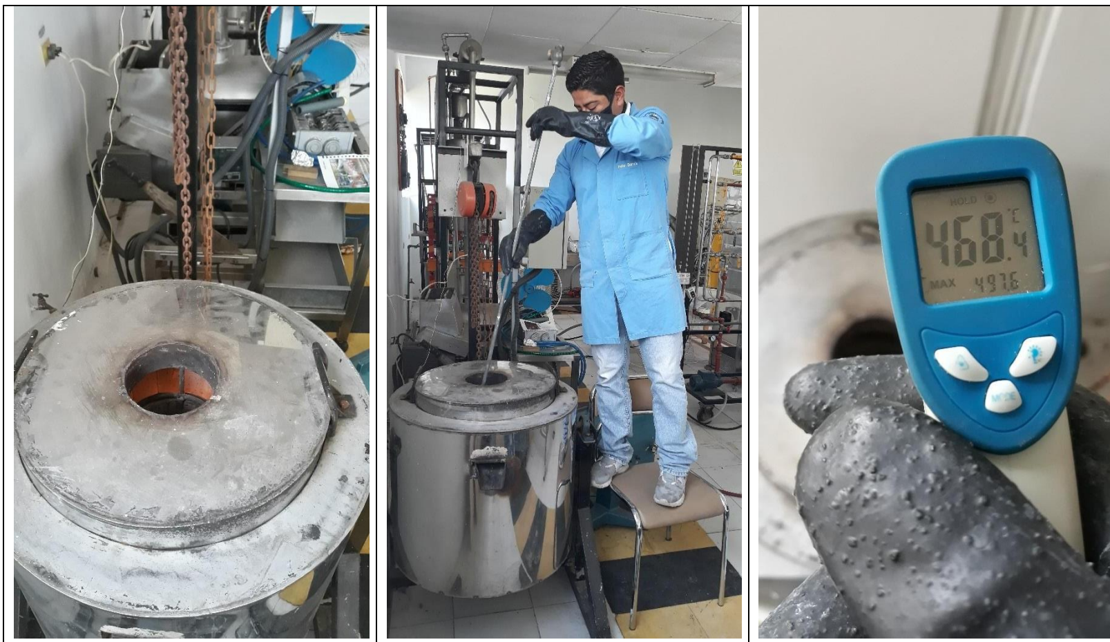
Pruebas de recubrimiento con zinc en el laboratorio de operaciones unitarias. Izquierda: fundición del zinc; centro: retiro de impurezas; derecha: temperatura del zinc fundido.
