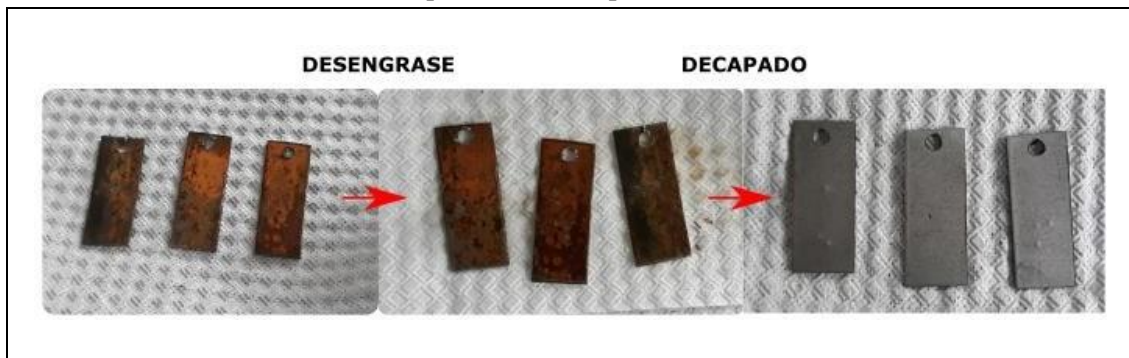
b) Placas tratadas con: desengrase basico, enjuagues y decapado (HCl).
