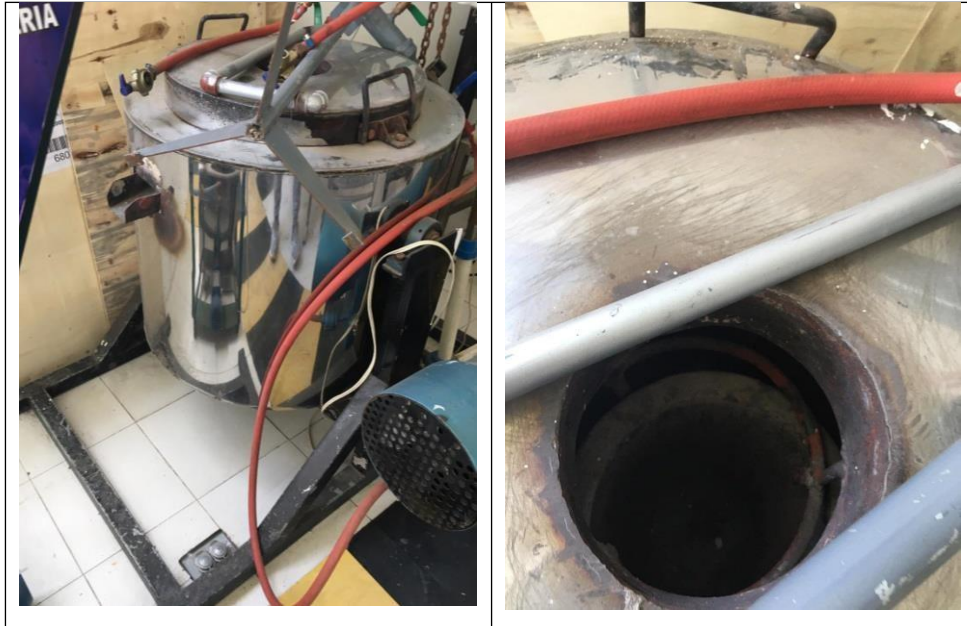
Figura 2-2. Horno de fundición para metales.
