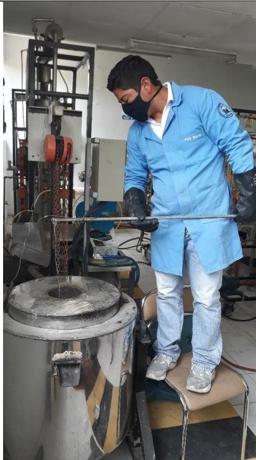
Inmersión de piezas en zinc fundido. Izquierda: Temperatura de los gases de combustión; centro: inmersión de piezas; derecha: zinc fundido en crisol
