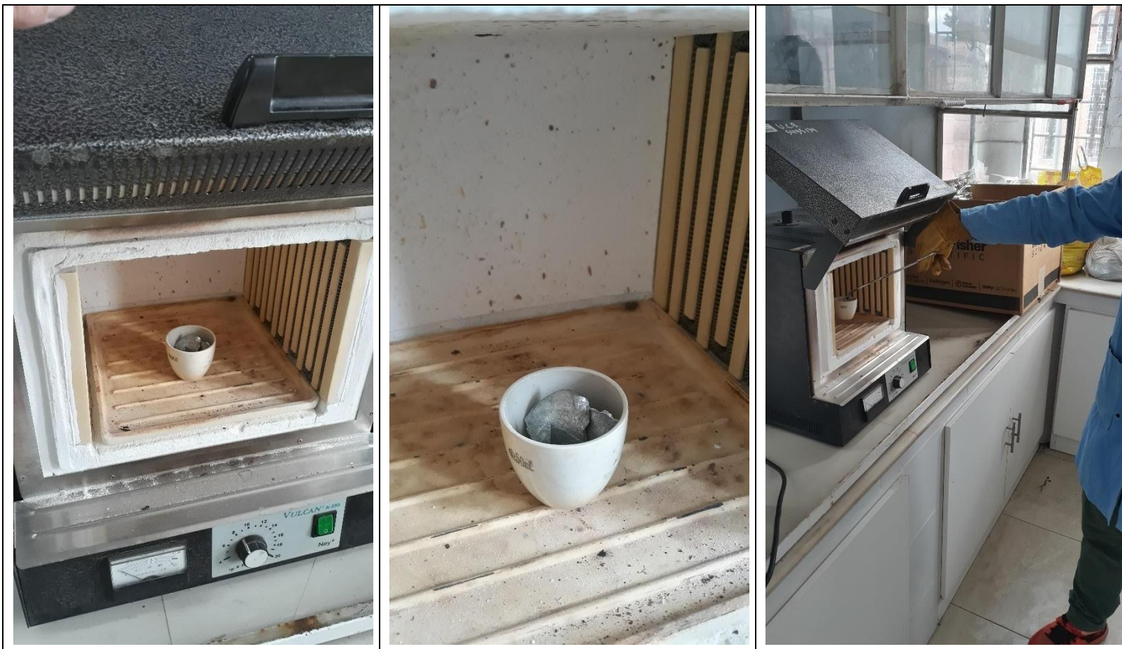
Pruebas de fundición del zinc usado para el recubrimiento.
