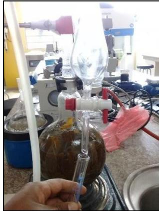
**Figura 5-3:** Separación del aceite esencial del agua
