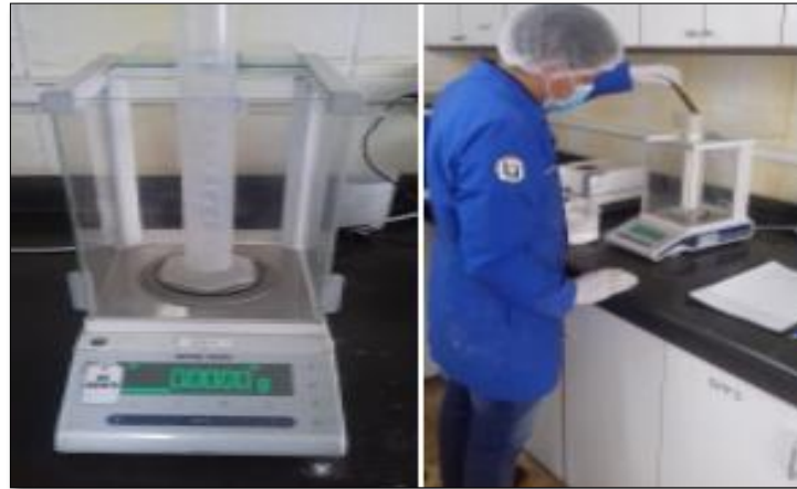
Fotografía 7-3: Determinación densidad de harina de trigo fortificada
