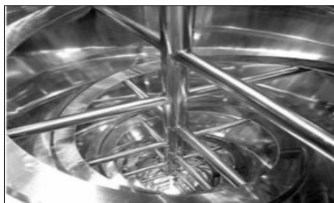
Figura 7-2: Mezclador de paletas
