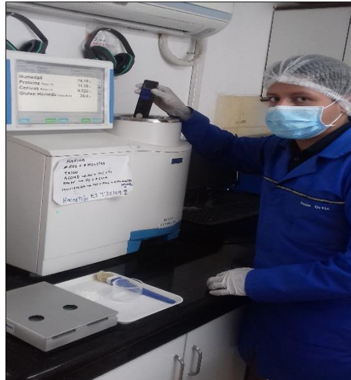
Fotografía 3-3: Caracterización en el equipo NIR
