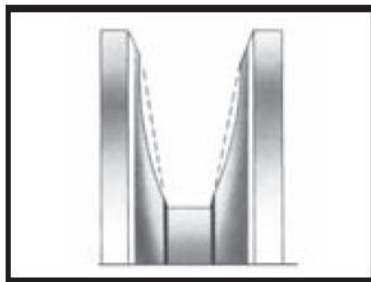
Las paredes presentan ranuras desgastadas
