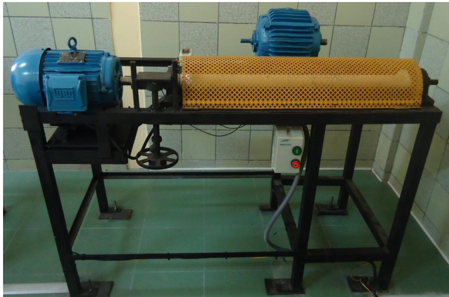
Figura. 3.3: Motor acople Reacondicionado.
